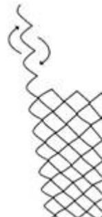
Na spodní části pletiva narovnáme konec drátu (spirály) a rozpleteteme spojení dvou sousedních drátů. Krouživým pohybem vypleteme krajní drát (plochou spirálu).
